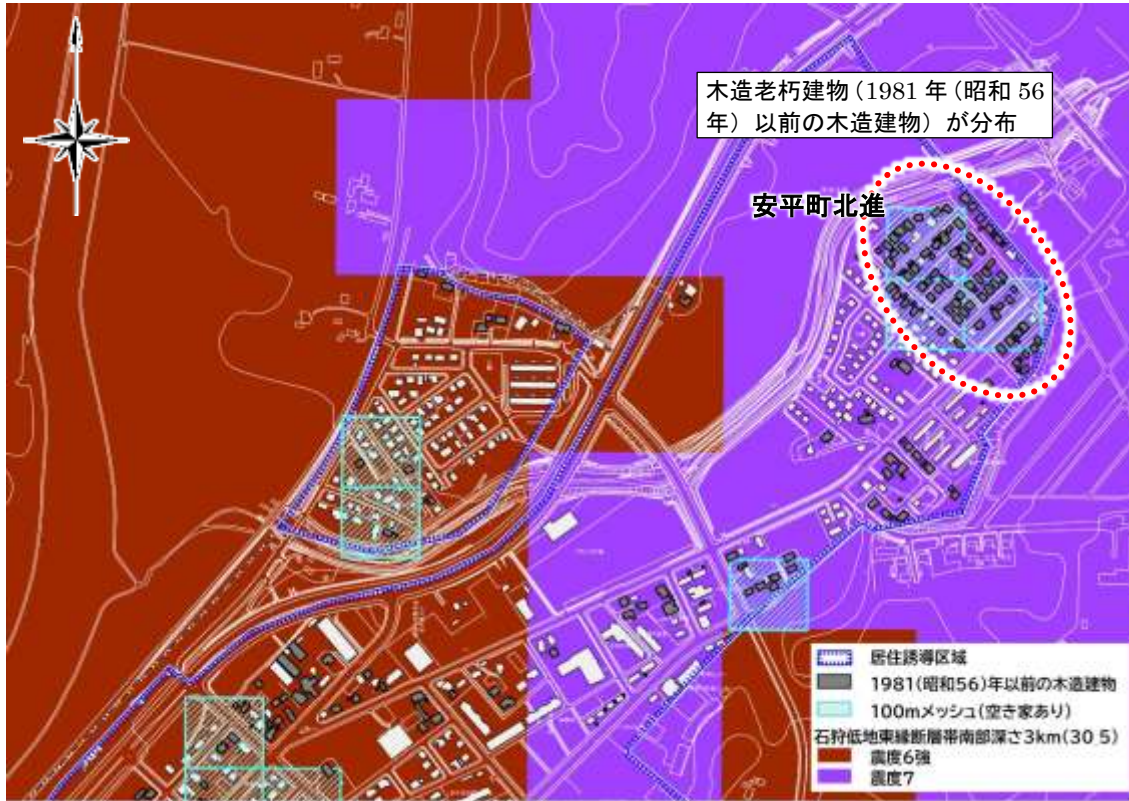
図 災害リスク分析（建物倒壊の危険性）：早来地区 北部
